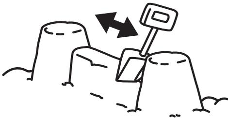
Con la pala cortamos el montículo para formar una pared recta. Recortamos la cima del montículo de forma horizontal. Con la cara posterior de la pala alisamos la superficie.
